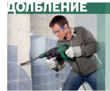
Вот как просто перфоратор Воѕсh превращается в отбойный молоток: просто нажмите на кнопку блокировки вращения, вставьте зубило SDS-plus и за работу. Система Vario-Lock для фиксации зубила в 36 положениях: благодаря этой системе положение плоского зубила легко регулируется под любые условия работы.
