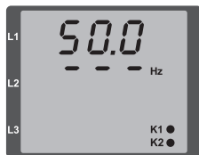
Рис. Установить направление вращающегося поля невозможно.
