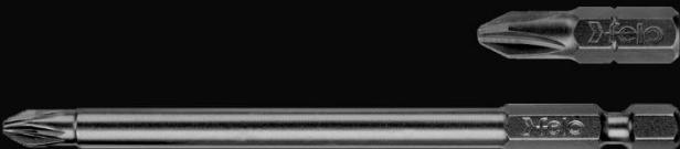
Биты FELO могут быть длиной от 25 до 150 мм. Короткие биты, длиной 25-32 мм подходят для выполнения большинства работ по сборке/разборке конструкций с легким доступом к крепежу, либо при работе через битодержатель. Для работы в труднодоступных местах целесообразнее применять оснастку с более длинным стержнем (73-150 мм).
